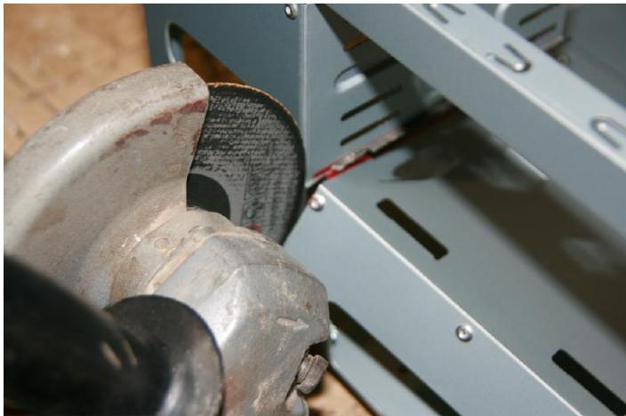
Mit einem Scheibenschneider trennen wir den unteren Boden ab, damit wir den Hot-Swap-Käfig einbauen können.
