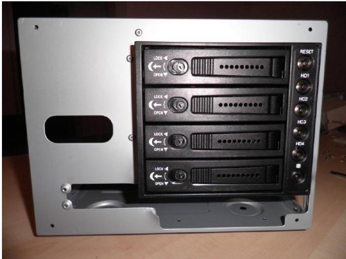
Zum Schluss bauen wir den Hot-Swap-Käfig ein. Danach können wir die modifizierte Gehäuseklappe montieren.
